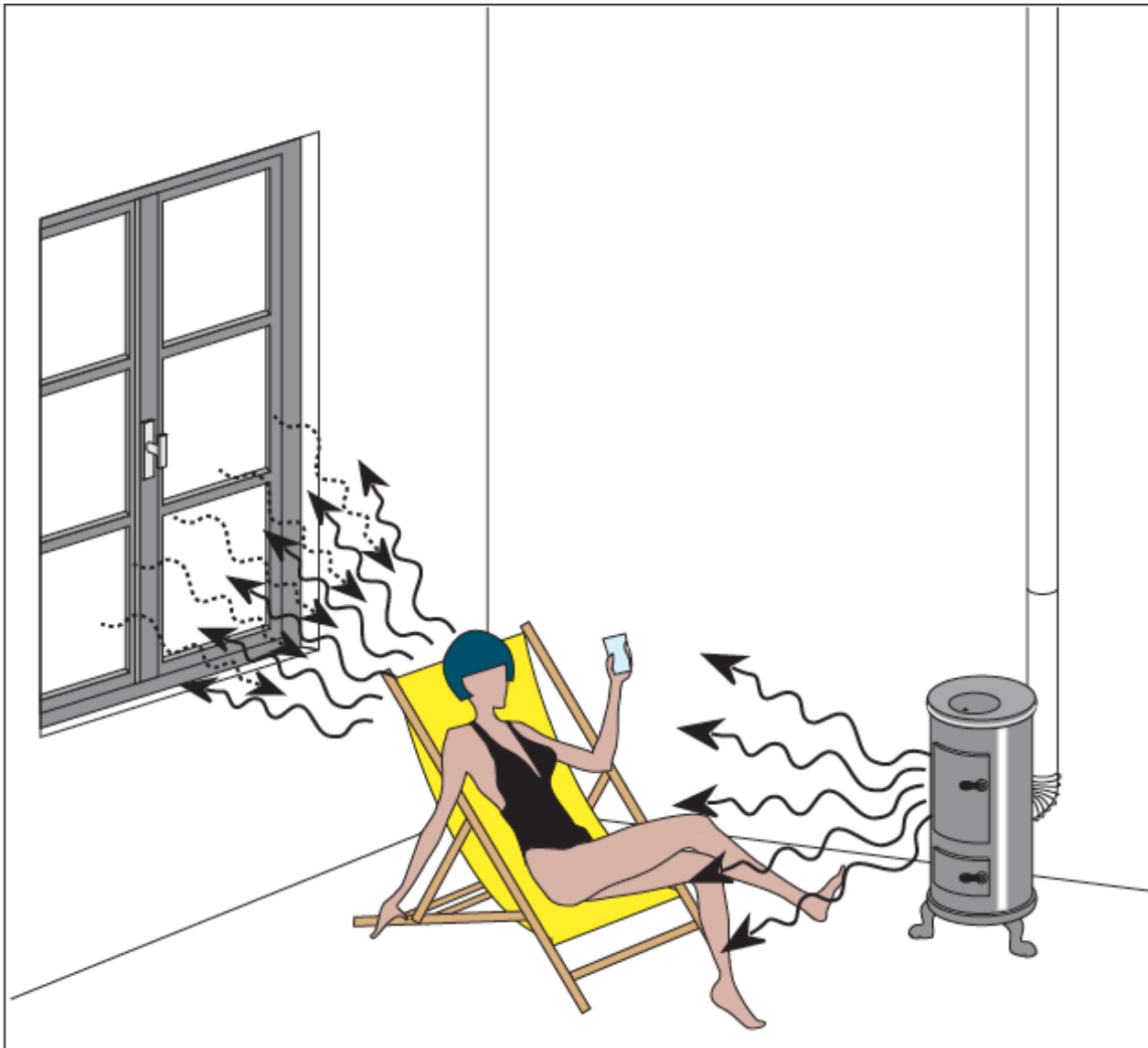
Transport de chaleur par rayonnement, Fenêtre et poêle (B. Paule)
